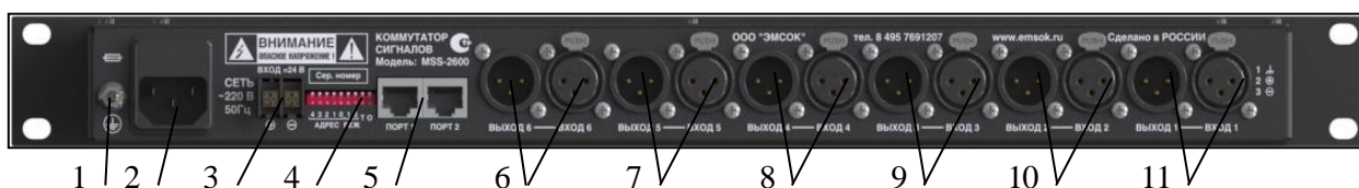
Рисунок 6.2. Задняя стенка коммутатора. 1 – Клемма защитного заземления, 2 – соединитель для подачи питания переменного тока и держатель плавкой вставки, 3 – соединитель для подачи питания постоянного тока, 4 – переключатели режимов, 5 – порты связи с БУС, 6-11 – входы-выходы каналов.
